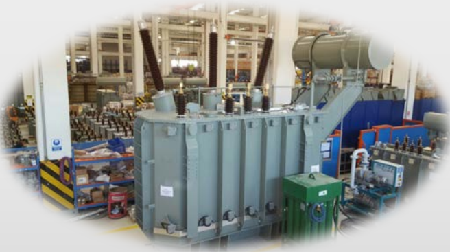
70 MVA, 154/34,5 kV ÇELİKLER HOLDİNG PROJESİ
