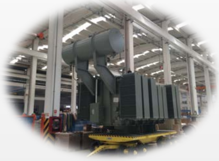
42 MVA 154/6,3 kV KAVÇIM ÇİMENTO PROJESİ
