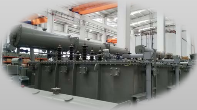
7,5 MVA NİJERYA TRANSFORMATÖRLERİ
